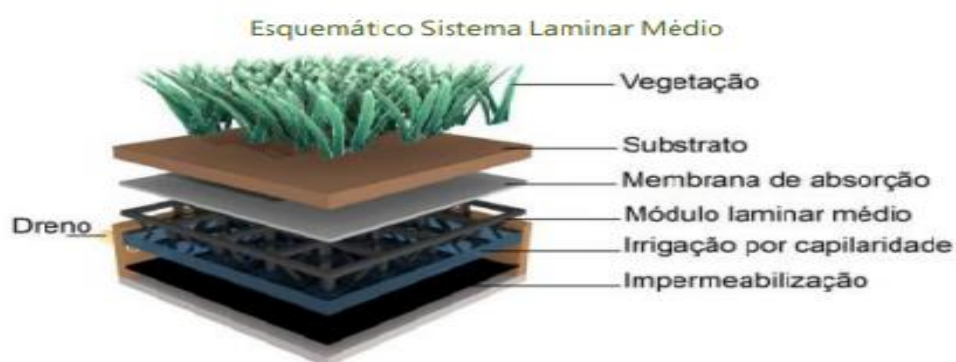
Detalhe: Altura de 5cm para escoamento da água
