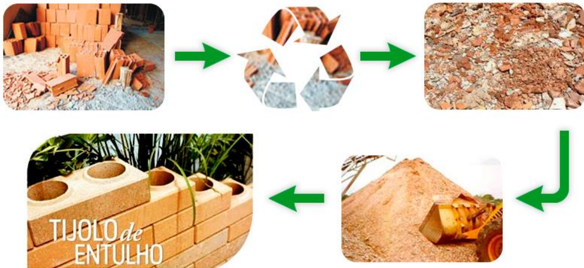
Figura 3. Processo básico da fabricação industrial do tijolo de entulho.
